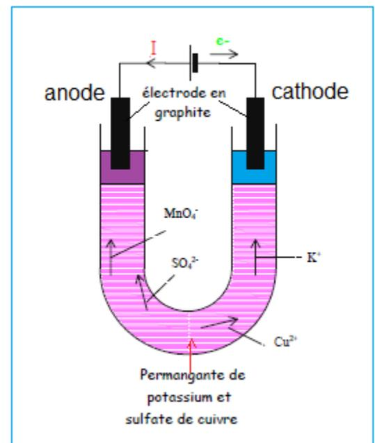
Le passage du courant électrique dans une solution résulte d'une double migration des anions et des cations se des anions se déplacent en sens inverse.
