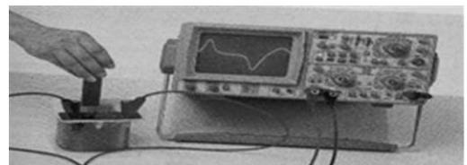
✚ le couplage électromécanique est un phénomène réciproque car il possible de transformer l'énergie mécanique en énergie électrique (principe de fonctionnement de l'alternateur) et vis vers ça.
